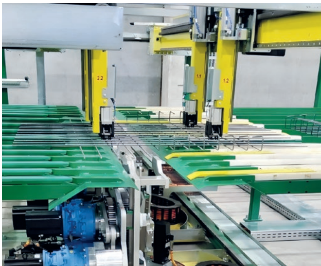
Travesaño con pinzas y sistema de doblado para mallas de armadura planas y dobladas
