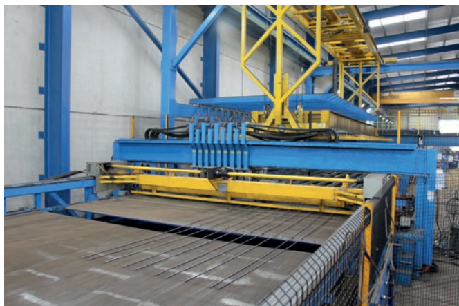
L'impianto di saldatura reti M-System Evolution di Byley aumenta sensibilmente l'efficienza operativa.
