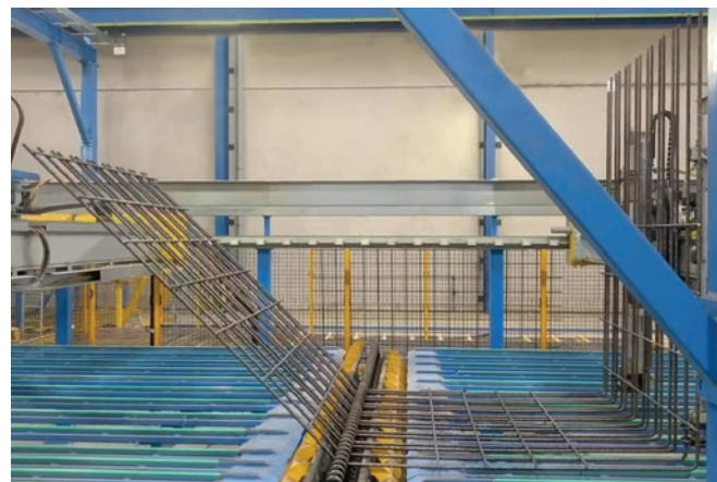
Due sistemi di piegatura consentono la produzione di gabbie di grandi dimensioni per elementi pesanti prefabbricati in calcestruzzo.
