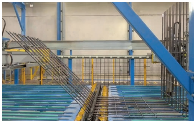
L'usine de Biley dispose de deux lignes de pliage distinctes pour la production de cages d'armature de grande taille destinées aux composants en béton lourds.
