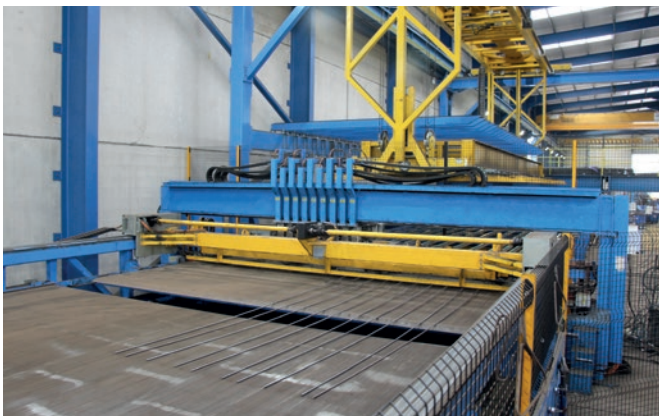
La ligne de soudage de treillis M-System Evolution installée à Biley améliore considérablement l'efficacité opérationnelle du site.
