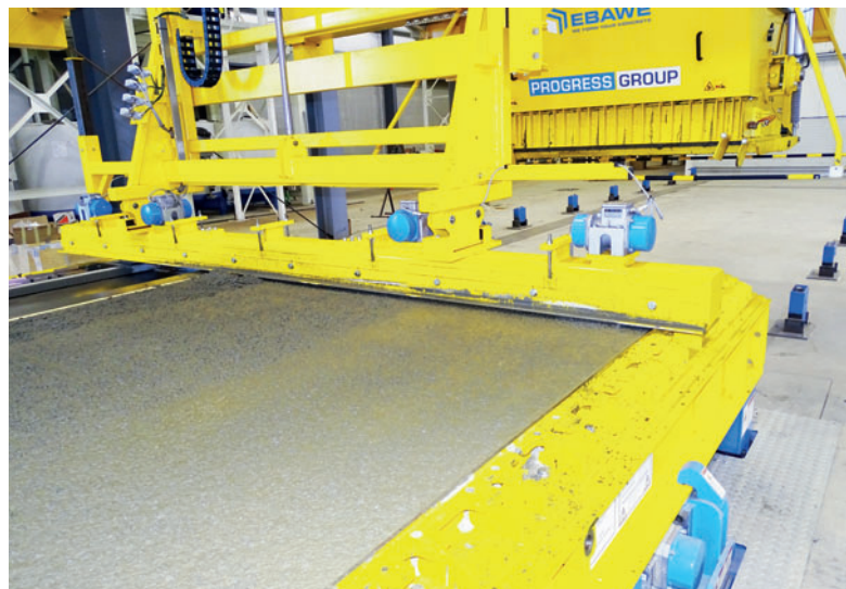
A barra niveladora montada no distribuidor de concreto aplaina o concreto, alisando-o e adensando-o de acordo com a profundidade da camada de concreto.
