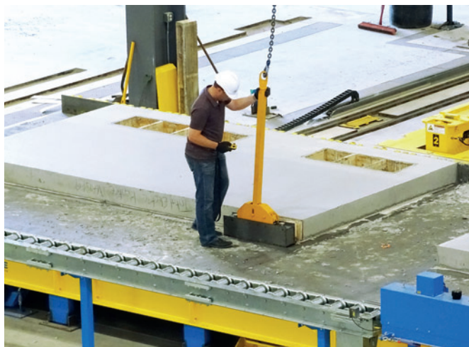
Robot szalunkowy znacząco podwyższa poziom automatyzacji produkcji. Rozformowywanie odbywa się manualnie z użyciem trawersy.
