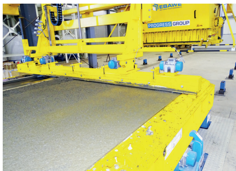
Listwa wygładzająca zamontowana przy rozścielaczu mieszanki betonowej ściaga nadmiar mieszanki betonowej, wyrównuje ją i zagęszcza odpowiednio do zaprojektowanej głębokości warstwy.
