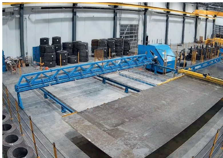
Nowa, w pełni zautomatyzowana linia zgrzewania siatek w zakładzie firmy Matbar.
