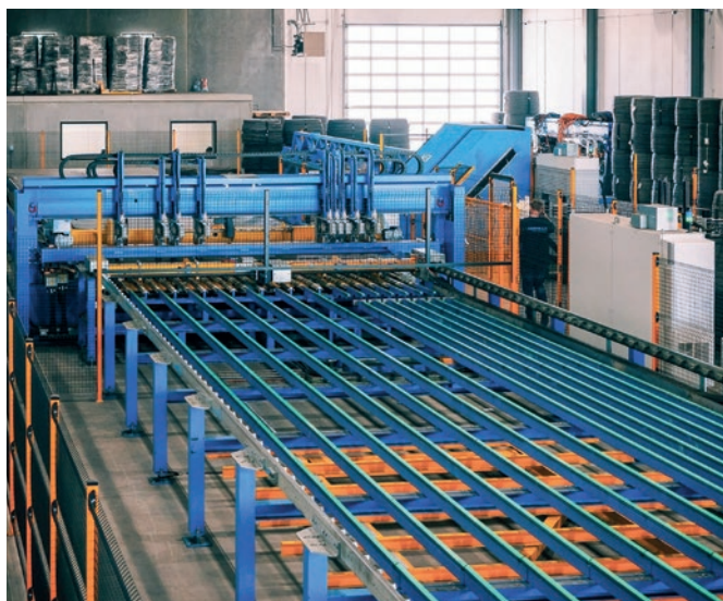
Nowa linia zgrzewania siatek M-System BlueMesh w zakładzie firmy Matbar.
