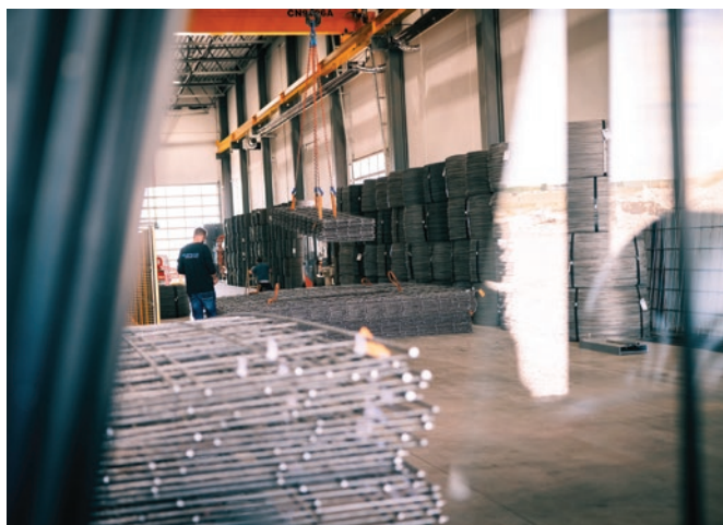
Gotowe elementy zbrojenia w zakładzie firmy Matbar.
