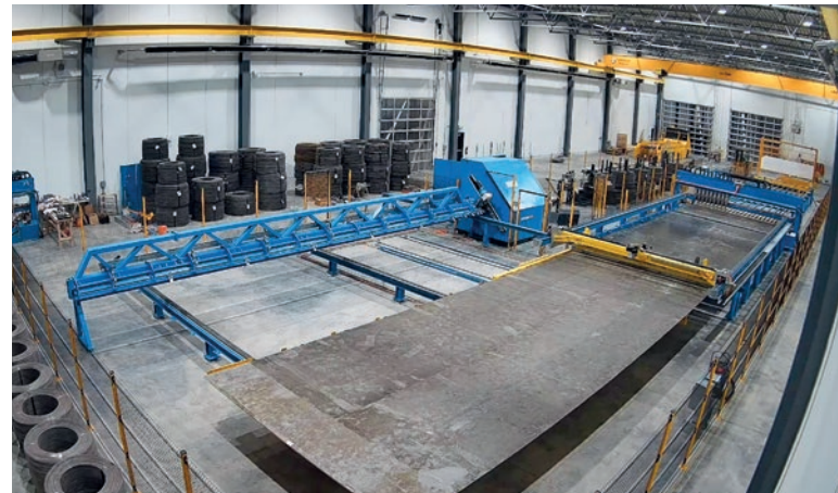
Production de treillis soudés à partir de couronnes
