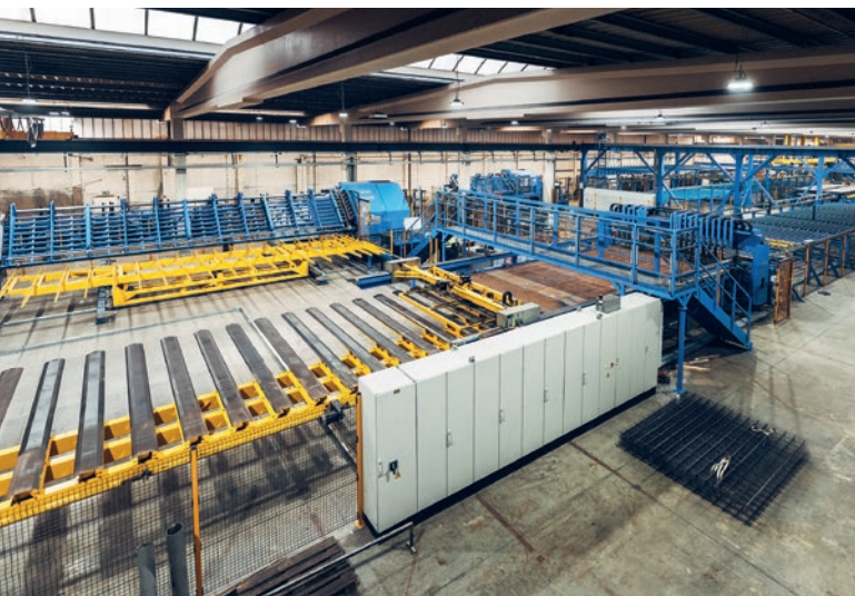
La instalación de soldadura de mallas M-System PowerMesh fabrica un gran número de mallazos a medida con distancias y doblados flexibles, lo que no solo aumenta la velocidad sino también el volumen de producción
